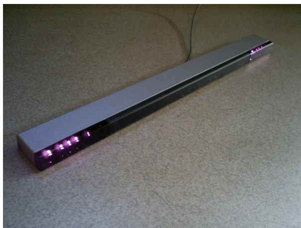
図 5.1: センサーバー赤外線をデジカメで撮影した様子
