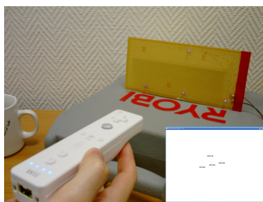
図 27: 赤外線 LED4 点で二等辺三角形を検出させる例
