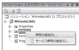
参照の追加から [参照] を選択し、WiimoteLib.dll を選択します。「マイドキュメント¥Visual Studio 2008¥Projects」に置いた「WiimoteLib\_1.7¥WiimoteLib.dll」を選択し、「OK」ボタンをクリックします。
