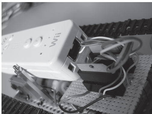
図9-29 LED信号をモータードライバーに接続
