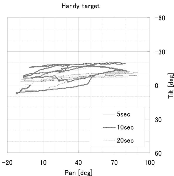
図 3: 動的目標撮影時の角度検出特性 (三脚上)
